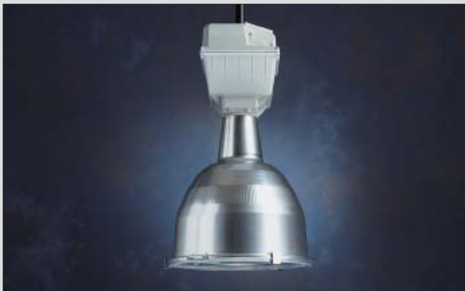
L'intérieur du réflecteur est facetté pour réduire la luminance et éviter la réflexion infra rouge vers la lampe
