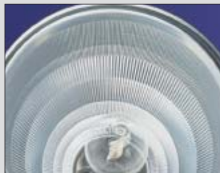
L'intérieur du réflecteur est facetté pour réduire la luminance et éviter la réflexion infra rouge vers la lampe
